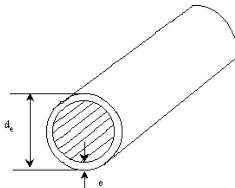
Figura 1: Corte de uma seção **reta** de Monotubo 40 x 3,2
